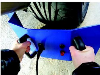
L'opération de démagnétisation prend environ 10 minutes par pneu. La démagnétisation est définitive pour toute la durée de vie du pneu. Il existe en Suisse une liste de garages qui propose ce service
